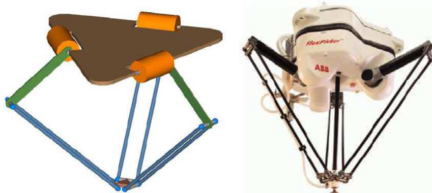
Figura 3: Robô paralelo do tipo delta: a) Três graus de liberdade b) Quatro graus de liberdade.
