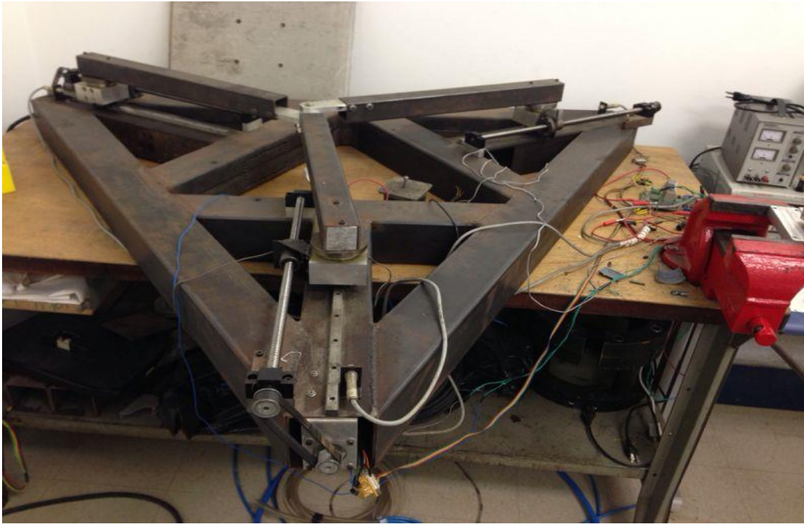
Figura 20: Vista Frontal (Motor de passo, Fuso, braço+guia)
