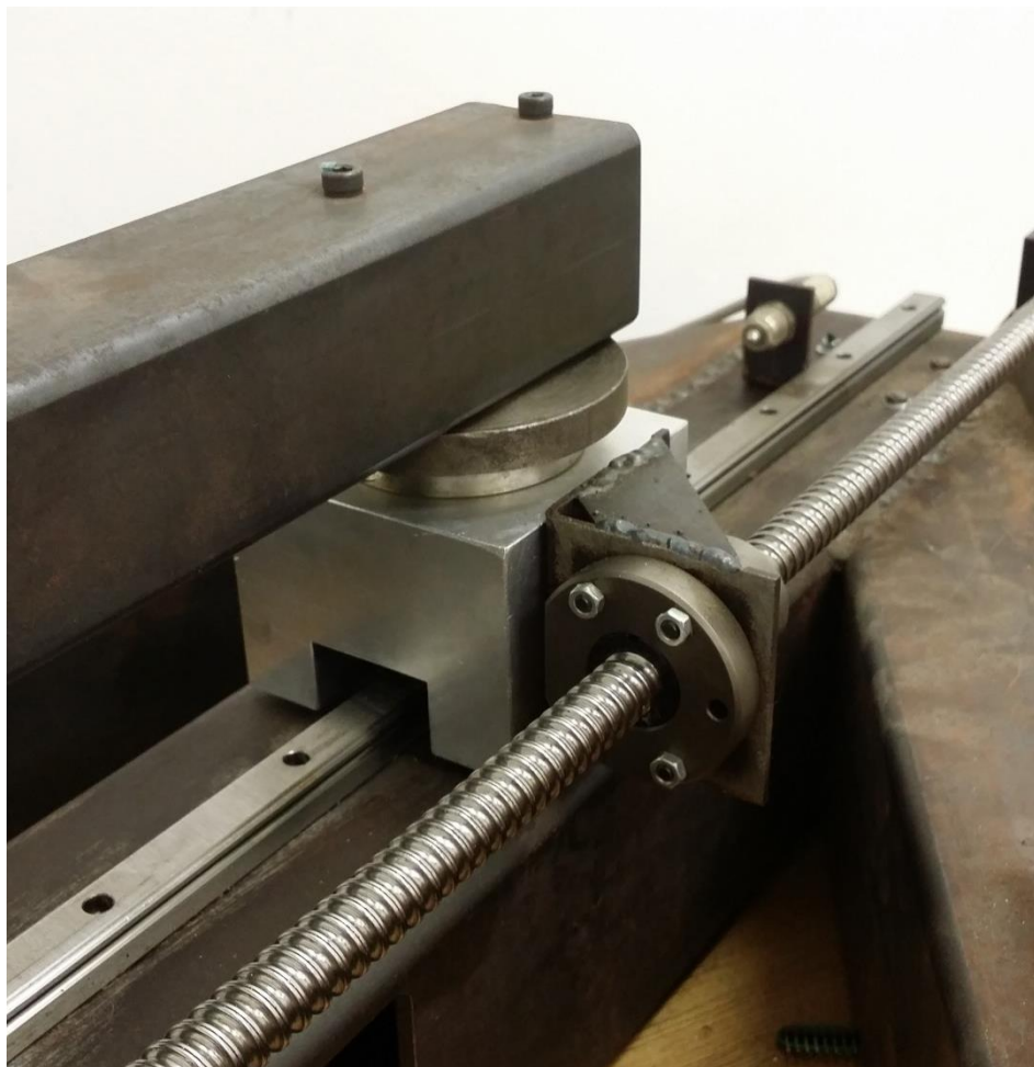
Figura 34: Montagem do novo acoplamento. Guia, fuso e eixo do braço
